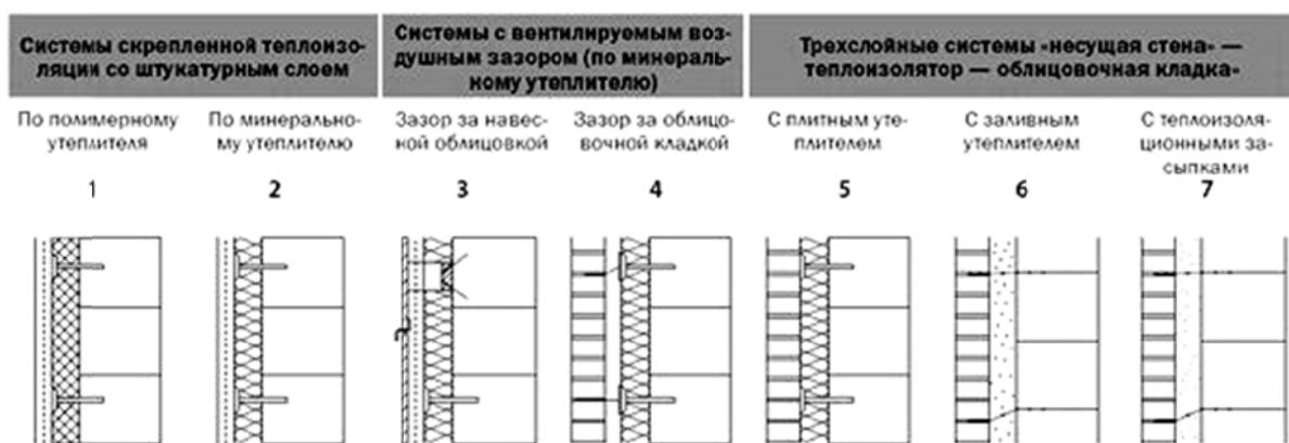
Рис. 20. Системы теплоизоляции
