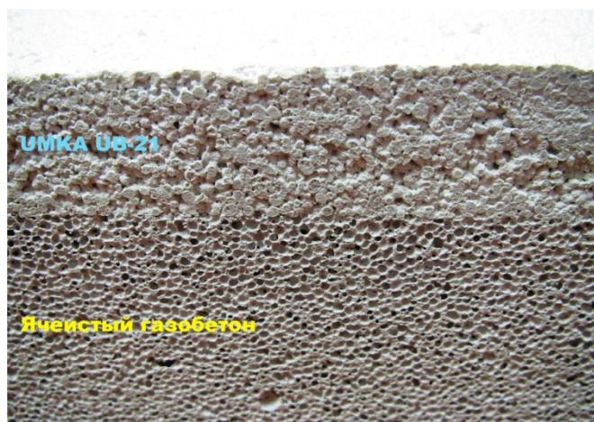
Рис. 1. Макросъемка среза штукатурного слоя UMKA UB-21, нанесенного на газобетон.
